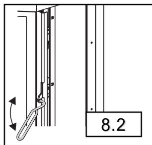
**Attention: la broche de blocage doit impérativement être placée en position B en usage normal, lorsque la porte peut être escamotée.**
