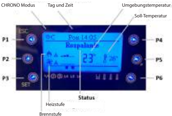
Abbildung 10. Touch Panel der Steuereinheit des Raumheizers VIKING – Beschreibung
