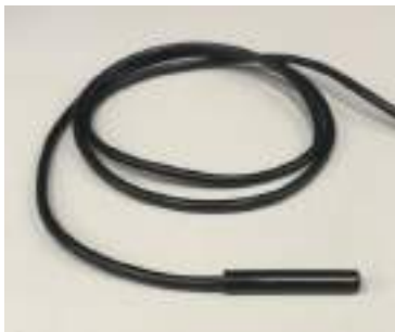
Dis. 7. Fuoriuscita del sensore di temperatura all'esterno: a) Smontaggio dello sportello di revisione, b) Sensore di temperatura
