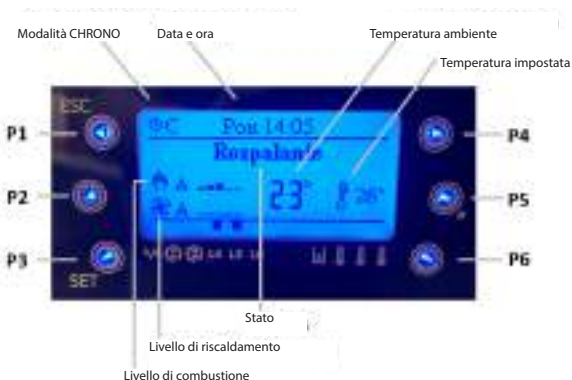
Dis. 10 Pannello di comando tattile della stufa VIKING - descrizione
