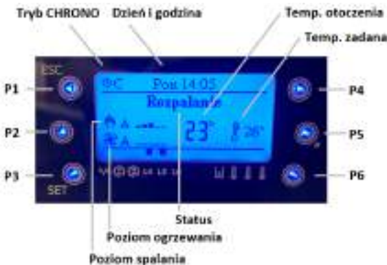
Rysunek 10. Dotykowy panel sterowania ogrzewacza VIKING – opis
